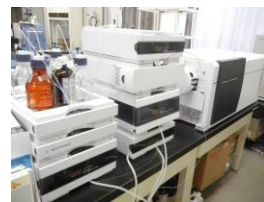
写真左: 高速液体クロマトグラフ質量分析装置(LC/MS)
